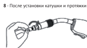
9 – прикрутить сварочный наконечник
