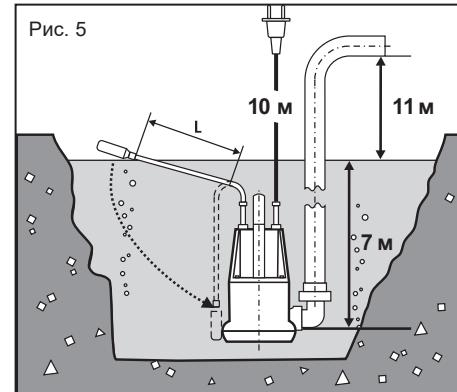
Насос начнет работать автоматически (в зависимости от положения поплавкового выключателя).
